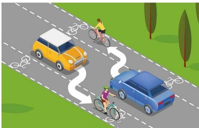
Le principe est de laisser plus de place aux vélos et piétons tout en responsabilisant les conducteurs de véhicules à moteurs qui doivent ralentir au profit des déplacements doux. Le stationnement est bien entendu formellement interdit sur la Chaucidou, c'est en effet un stationnement gênant en pleine voie ou un stationnement sur bande cyclable ( de 35 à 135€)
